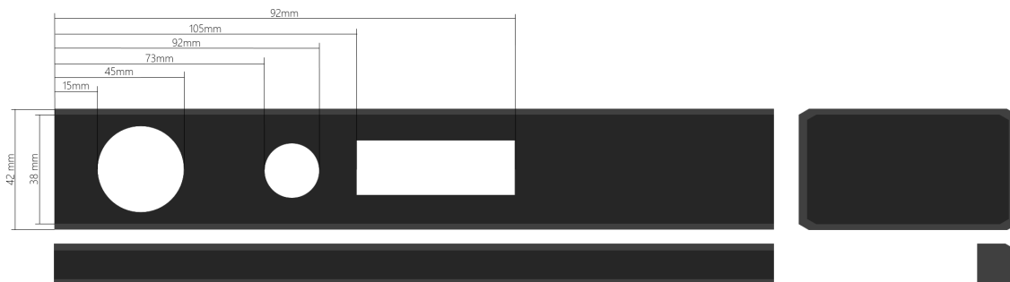
Abbildung 3.3.: Abmessungen der Kinect. Der Tiefensensor liegt in der kleinen runden Öffnung. Quelle:[Kinb]
