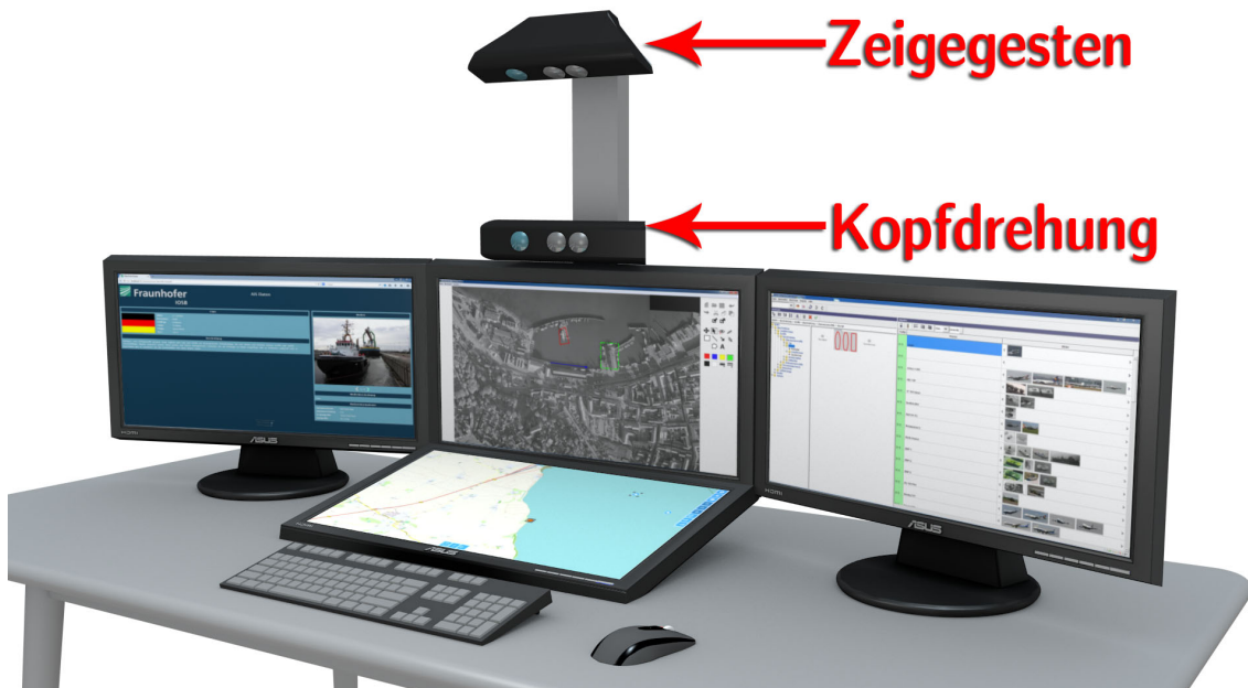
Abbildung 1.2.: Der Bildauswertepplatz mit zwei Kinect-Kameras zur Erkennung von Zeigegesten sowie zum Erfassen der Kopfdrehung
