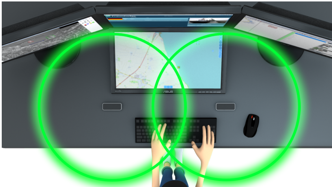
Abbildung 4.3.: Positionierung der Sensoren am Bildauswertepplatz der Zukunft. Die grünen Kreise visualisieren den Bereich, in dem Finger und Hände erkannt werden.
