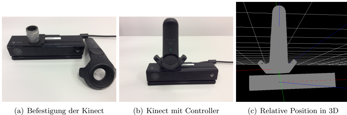
Abbildung 3.4.: Befestigung des Controllers an der Kinect. Die Mitte des Controllers ist direkt über dem Tiefensensor. In Bild 3.4(a) ist die 3D gedruckte Halterung zu sehen. Der Controller wird auf den Zylinder gesteckt. In 3.4(c) ist die virtuelle Repräsentation. Koordinatenkreuze zeigen den jeweiligen Ursprung des Geräts (X-, Y- und Z-Achse in rot, grün und blau)
