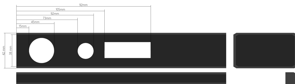
Abbildung 3.3.: Abmessungen der Kinect. Der Tiefensensor liegt in der kleinen runden Öffnung. Quelle:[Kinc]
