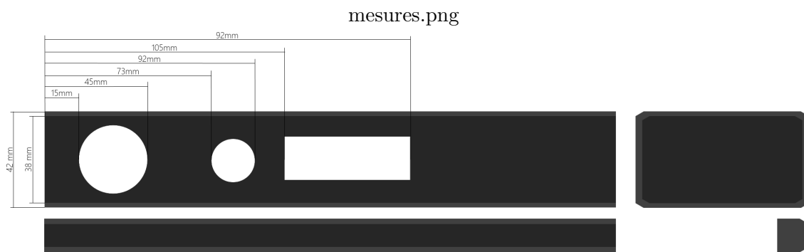
Abbildung 3.3: Abmessungen der Kienct. Der Tiefensensor liegt in der kleinen runden Öffnung. Quelle:[Kinb]
